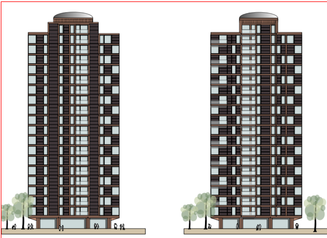
Figuur 9 - Gevelbeelden Zuidgevel met zonneshoorstenen links – Oost-en Westgevel rechts
